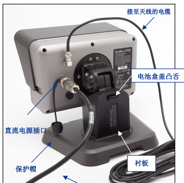
直流电源电缆和安装在 FSD 远程显示器上的衬板
