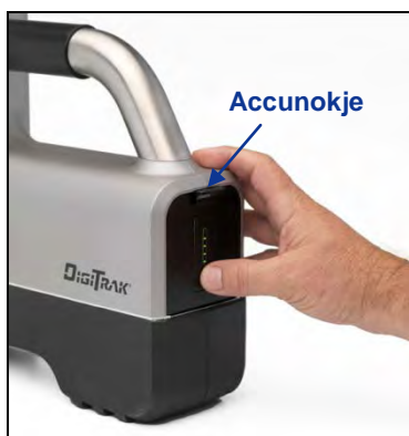
Accu correct geplaatst
