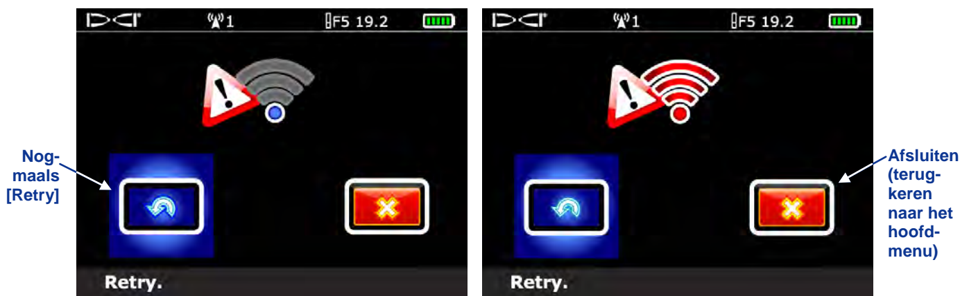
Kalibratiefoutschermb – signaalsterkte te laag (links) of te hoog (rechts)
