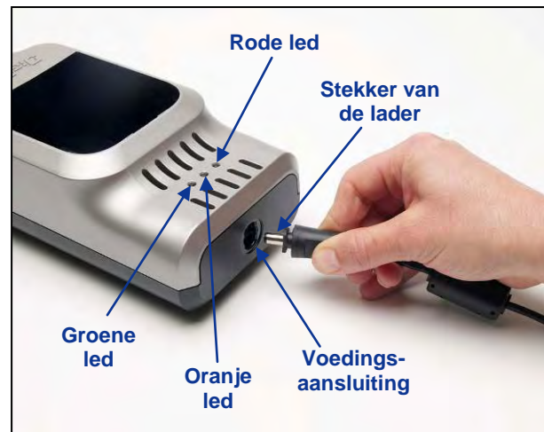
De stekker van de lader aansluiten op de voedingsaansluiting
