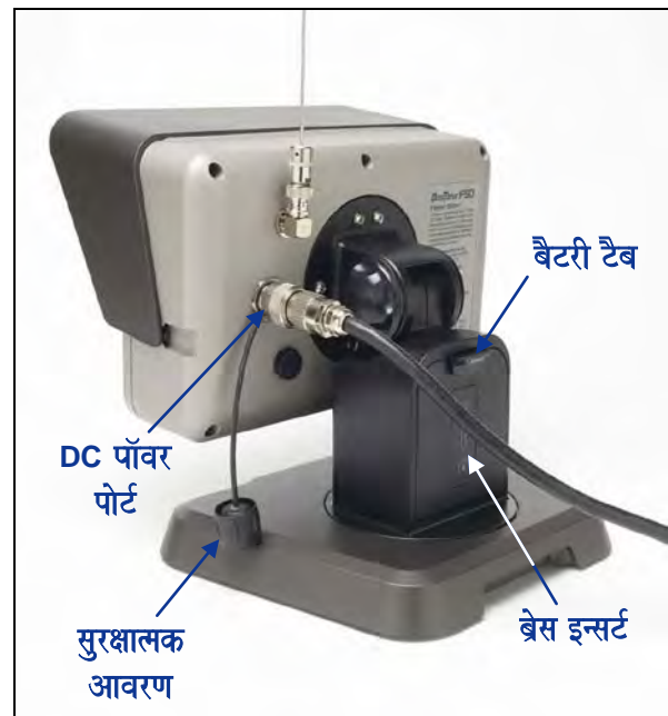
FSD रिमोट में लगाया गया DC पॉवर केबिल तथा ब्रेस इन्सर्ट
