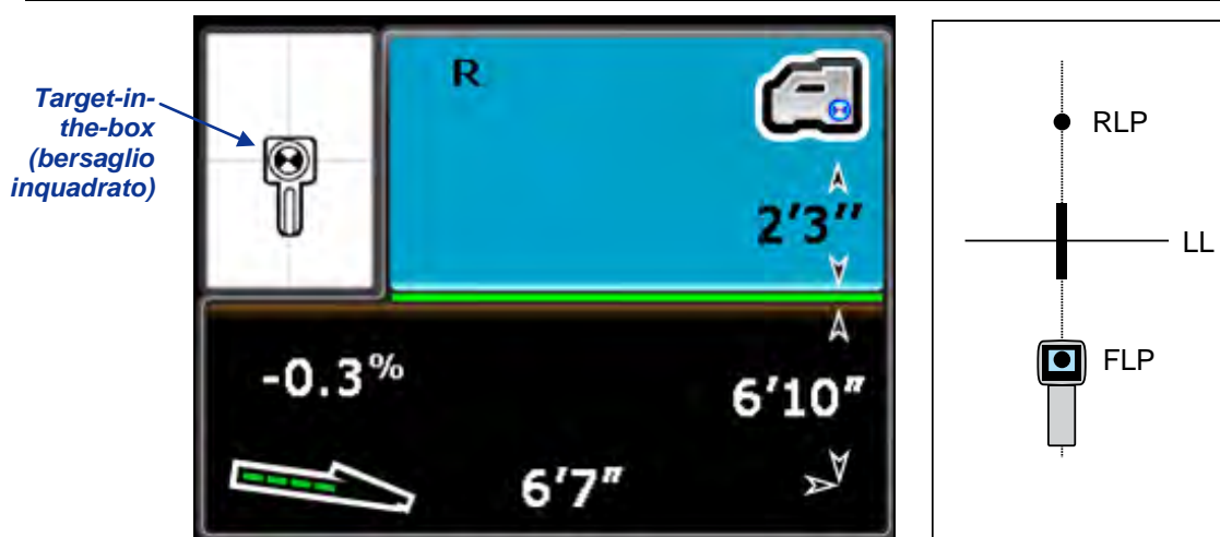
Schermata della modalità profondità del ricevitore (sul punto FLP con funzione DDT attivata)
