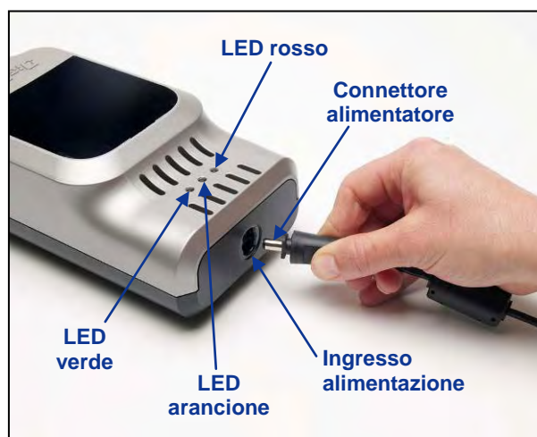
Inserimento del connettore dell'alimentatore nella presa di alimentazione
