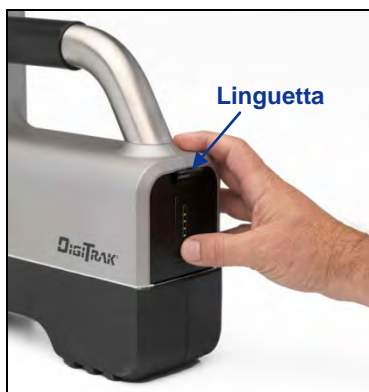
Batteria ricaricabile completamente inserita
