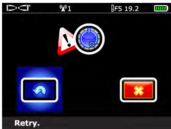
Ekran nieudanej kompensacji przechyłu
