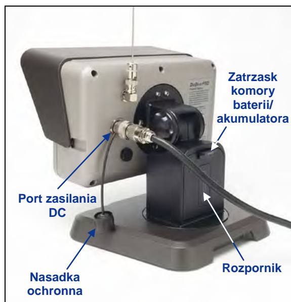
Kabel zasilający DC i rozpornik zamontowany w zdalnym urządzeniu FSD
