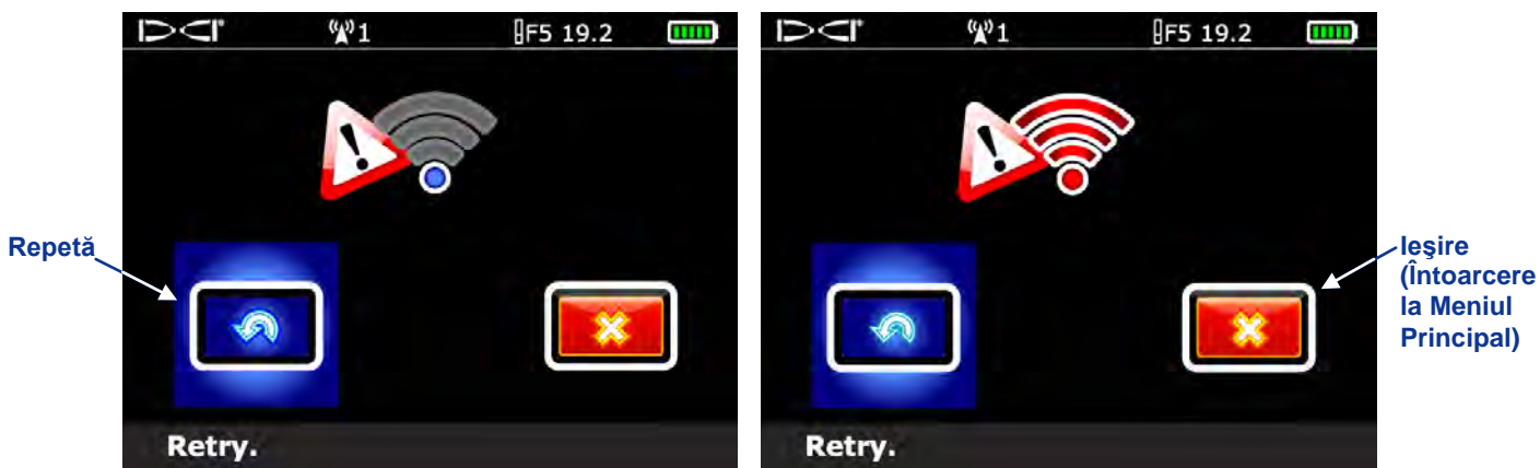
Ecranul de eroare calibrare – Putere semnal pre mică (stânga) sau prea mare (dreapta)
