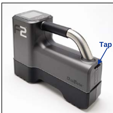
Batterikassetten helt isat
