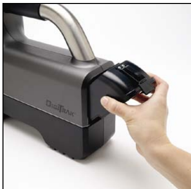
Einlegen der Batterie
