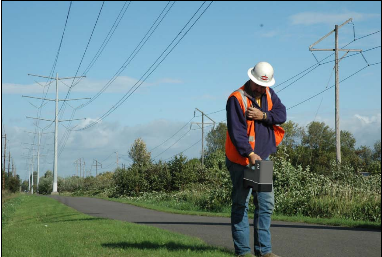
Orten mit dem F2 Empfänger in einem Gebiet mit starken Störungen
