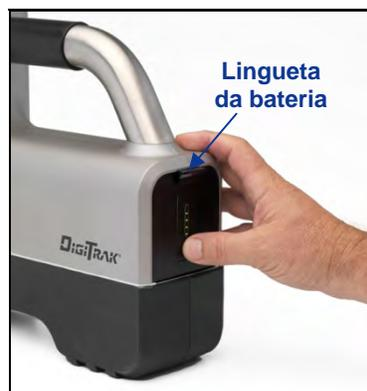
**Pacote de baterias completamente inserido**
