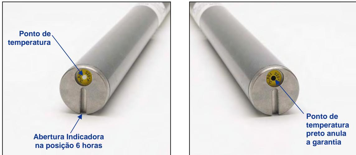
***Tampa dianteira do transmissor mostrando ponto de temperatura, abertura indicadora e ponto de temperatura preto.***
