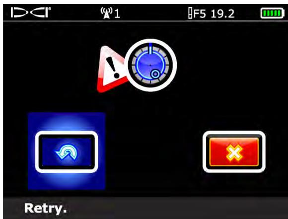
**Tela de falha de compensação de rotação**
