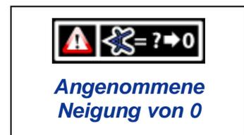
Wenn die Roll-Offset-Funktion verwendet wird (eine elektronische Korrektur, um die 12-Uhr-Position des Senders an die 12-Uhr-Position des Bohrkopfs anzugleichen), erscheint die Drehungsanzeige wie in der nebenstehenden Abbildung gezeigt. Weitere Angaben zur Funktion "Roll-Offset" finden Sie unter *Roll-Offset einstellen* im Abschnitt *Systemeinrichtung*.
