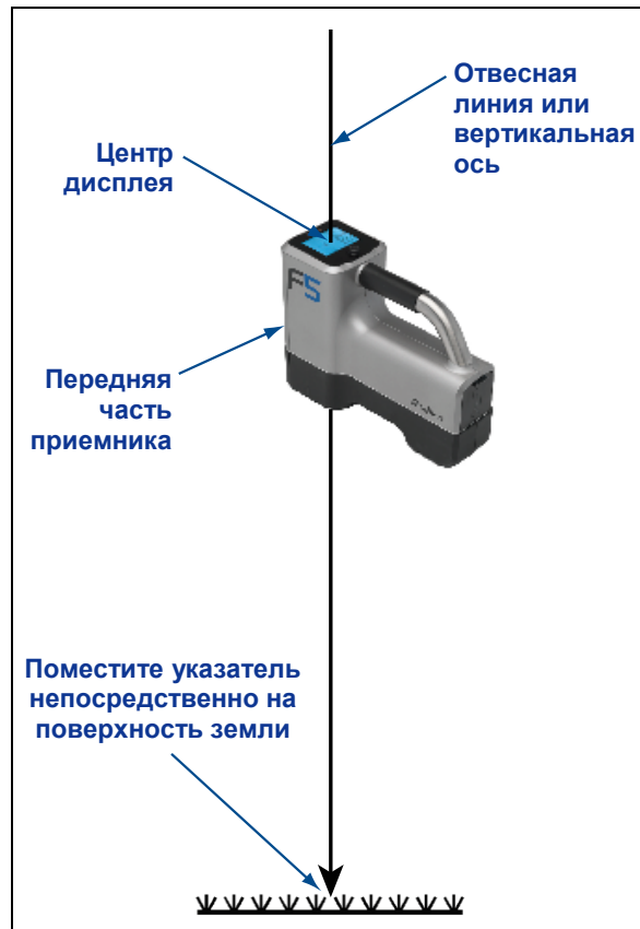
Отвесная линия для маркировки точек локации
