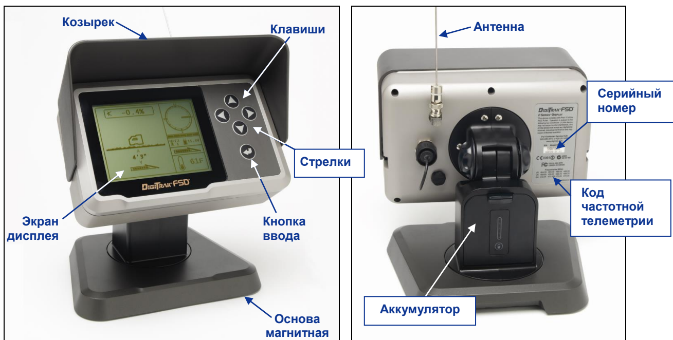
Удаленный дисплей серии DigiTrak F (FSD). Вид спереди и сзади
