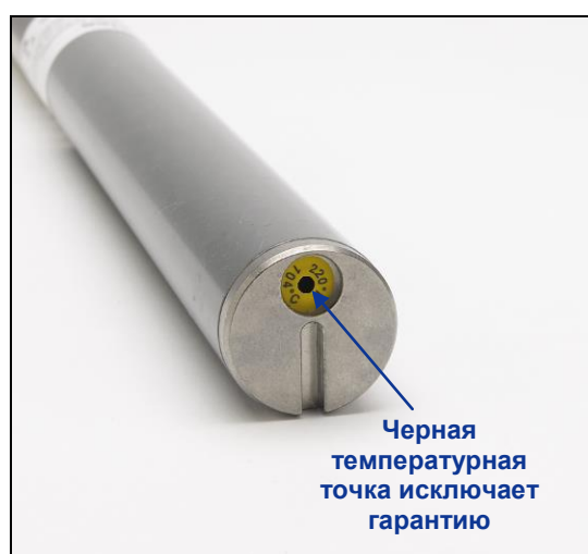
Передний торец зонда с нормальной температурной точкой, черной температурной точкой и прорезью
