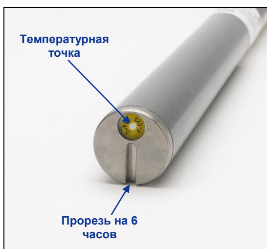
Передний торец зонда с нормальной температурной точкой, черной температурной точкой и прорезью
