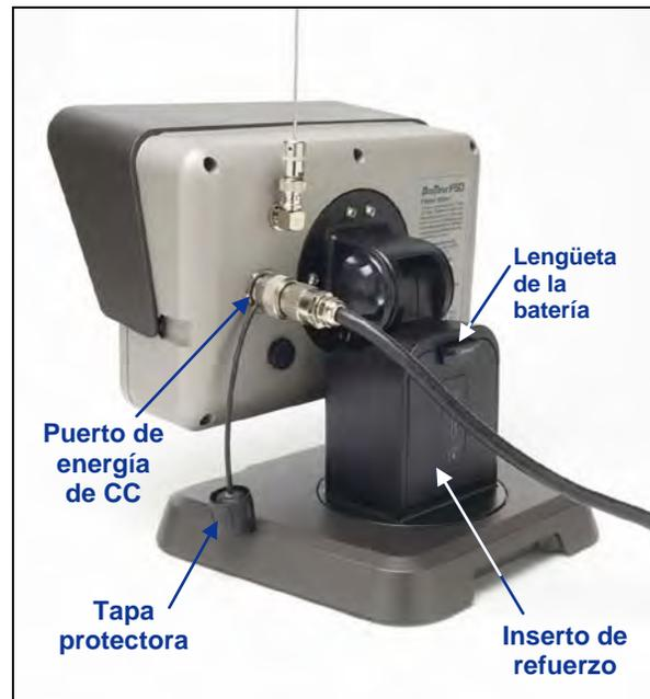
**Cable de CC e inserto de refuerzo instalado en la FSD remota**
