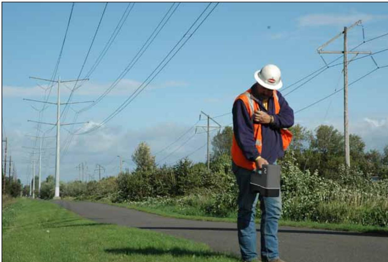
***Localizar em área de alta interferência com receptor F2***
