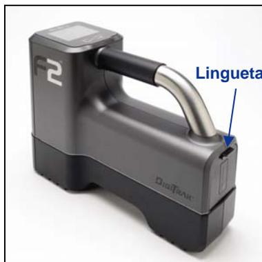
**Pacote de baterias completamente inserido**
