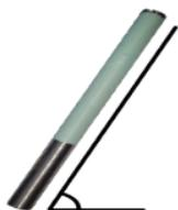
Tenere il trasmettitore alla stessa posizione generale dell'orologio (a ore  $\pm 2$ ) per l'intera procedura. Lasciare il trasmettitore acceso su un terreno livellato ( $0 \pm 10^\circ$ ) per almeno cinque secondi. Inclinare il trasmettitore di circa  $+65^\circ$  (quasi verticale) per 10-18 secondi, quindi riportarlo in posizione livellata per 10-18 secondi. Quando il trasmettitore cambia le bande, i dati scompaiono dal localizzatore.
