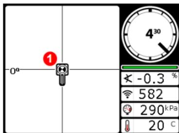
接收器定位屏幕，前定位点(FLP)上的Ball-in-the-Box(定位球入框)
