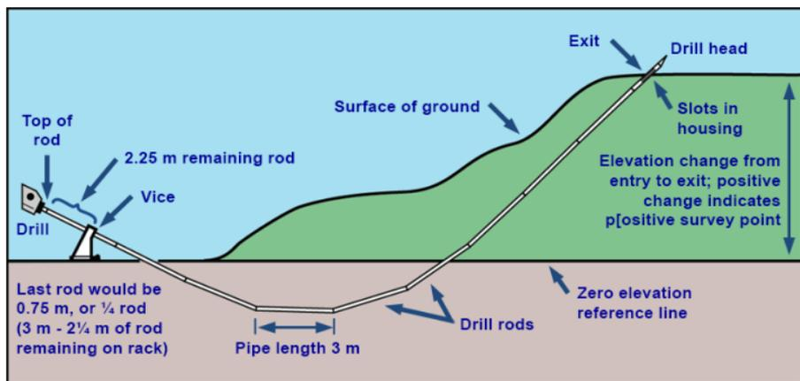
最后一个钻杆即为0.75米或 $\frac{1}{4}$ 钻杆(3米-2.25米的机架上所剩钻杆)。
