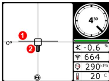
接收器定位屏幕，定位线(LL)上的Line-in-the-Box(方框中的线条)
