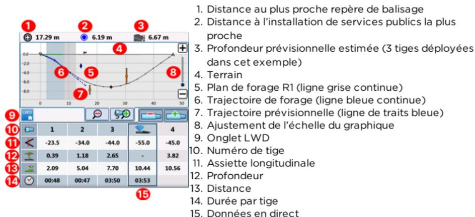
Quand vous enregistrez les données, la commande d'enregistrement affiche la profondeur et l'assiette longitudinale de la tête de forage (blocs de couleur verte) à côté de la profondeur et de l'assiette longitudinale anticipées.
