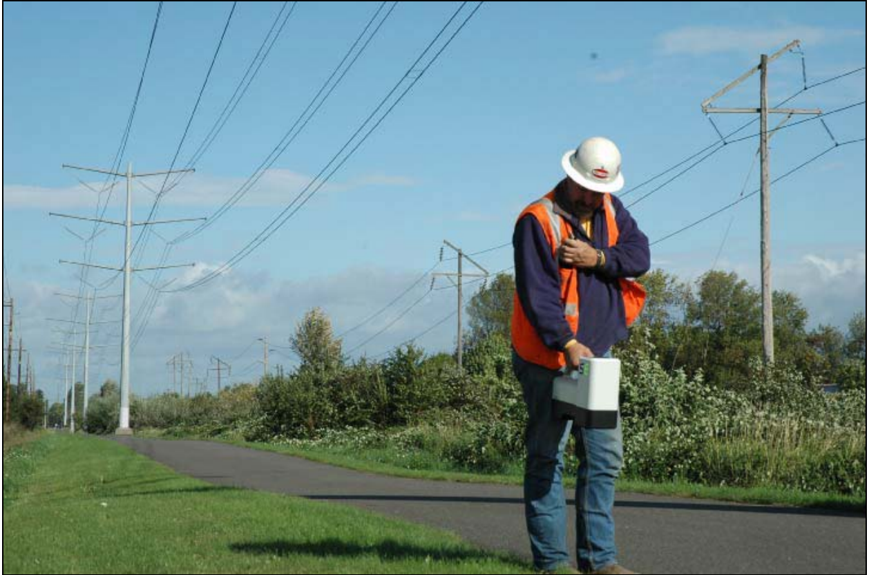
使用 SE 接收器在高干扰地区进行定位操作
