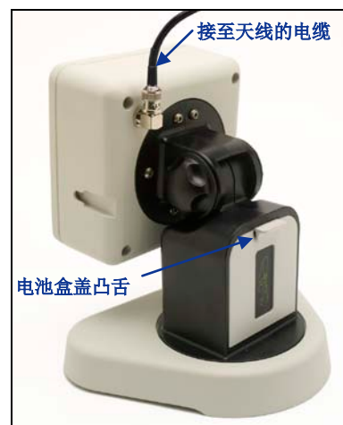
SED 远程显示器，电池组和天线已安装
