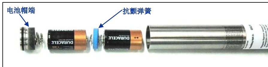
安装传感器电池——采用了抗颤弹簧
