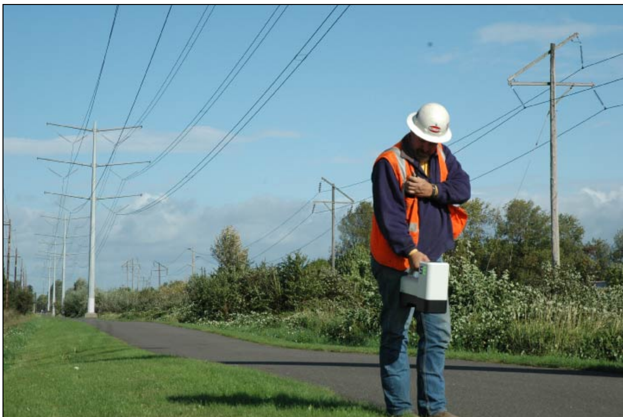
Lokalizacja w terenie o dużej gęstości interferencji przy pomocy urządzenia SE
