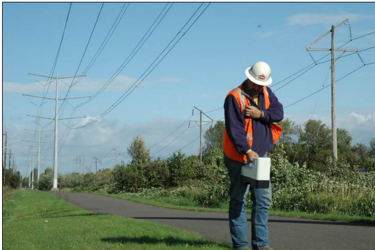
Локализация с приёмником SE в зоне высокого уровня помех
