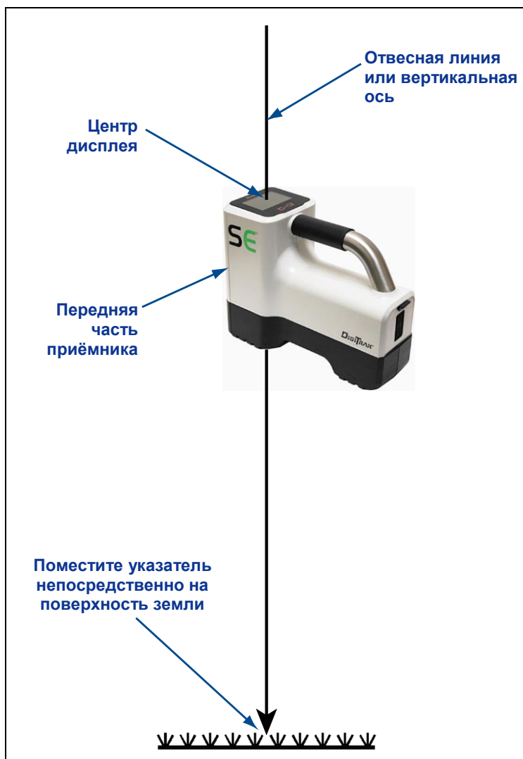
Отвесная линия для маркировки точек локализации
