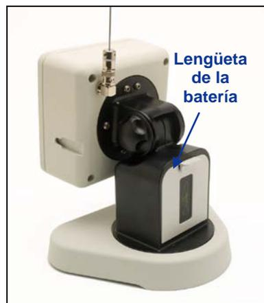
**Unidad SED remota con el paquete de batería instalado**
