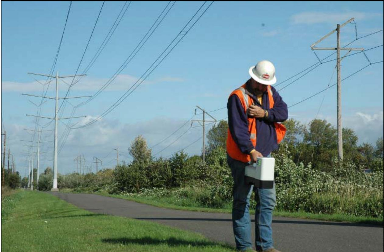
*Localización en un área de alta interferencia con el receptor SE*
