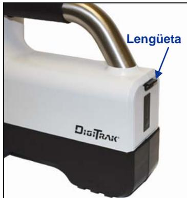
*Paquete de baterías completamente insertado*
