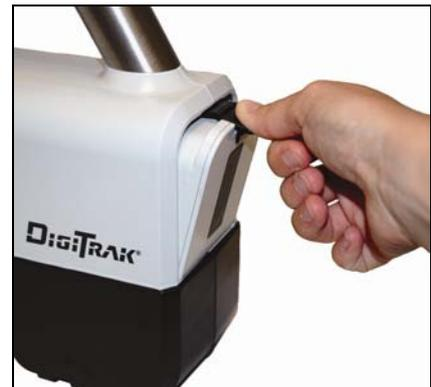
*Desmontaje del paquete de baterías*
