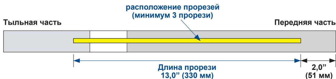
**Примечание:** Большинство корпусов зондов сделаны для излучателей длиной в (381 мм) с размерами прорезей 203 мм.
