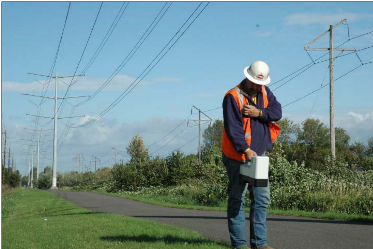
Helymeghatározás nagy interferenciájú területen SE vevővel
