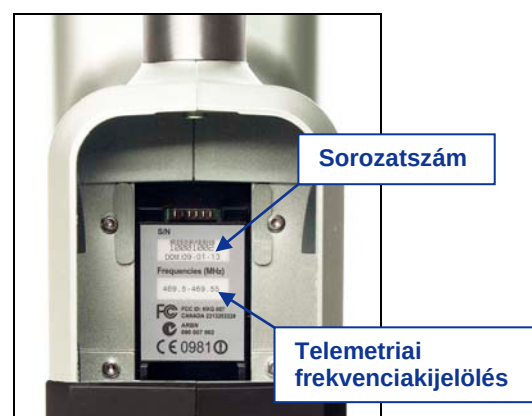
Sorszámozott címke az akkumulátorházban
