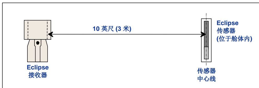
单点校准的 10 英尺距离测量
