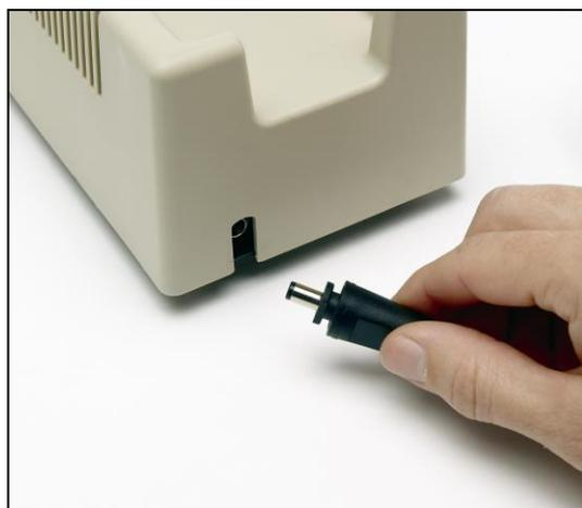
**Установка штекера зарядного устройства в разъем электропитания**
