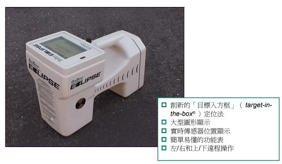
DigiTrak® Eclipse®地下定位系統 (iGPS®) 是用於水平導向鑽進工業的革新追蹤系統。首創以「實時」俯瞰的方式顯示鑽頭位置和定位點。
