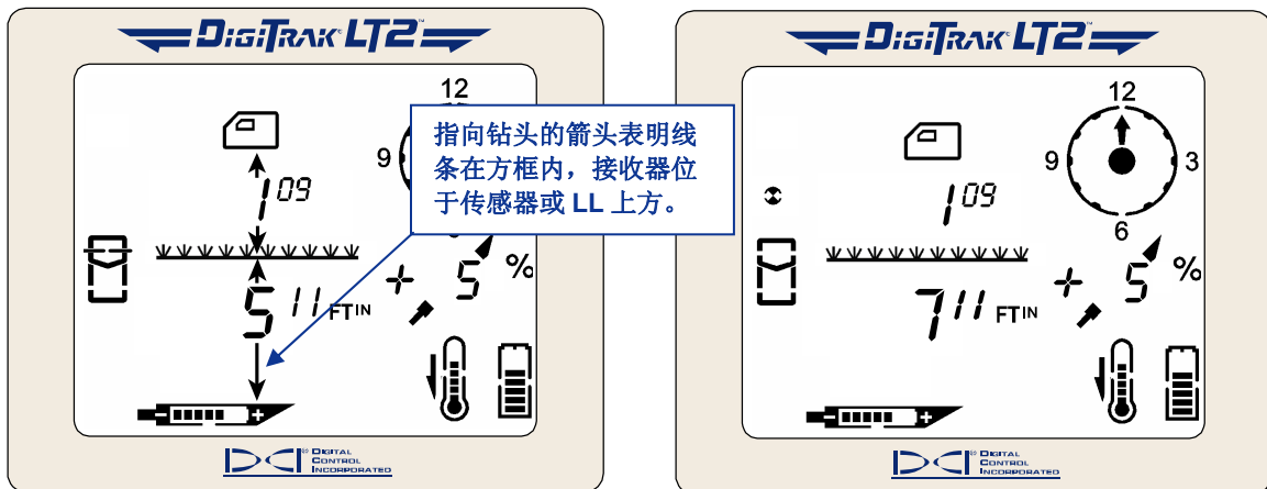
定位线在方框内 有箭头表示读数为实际深度。
