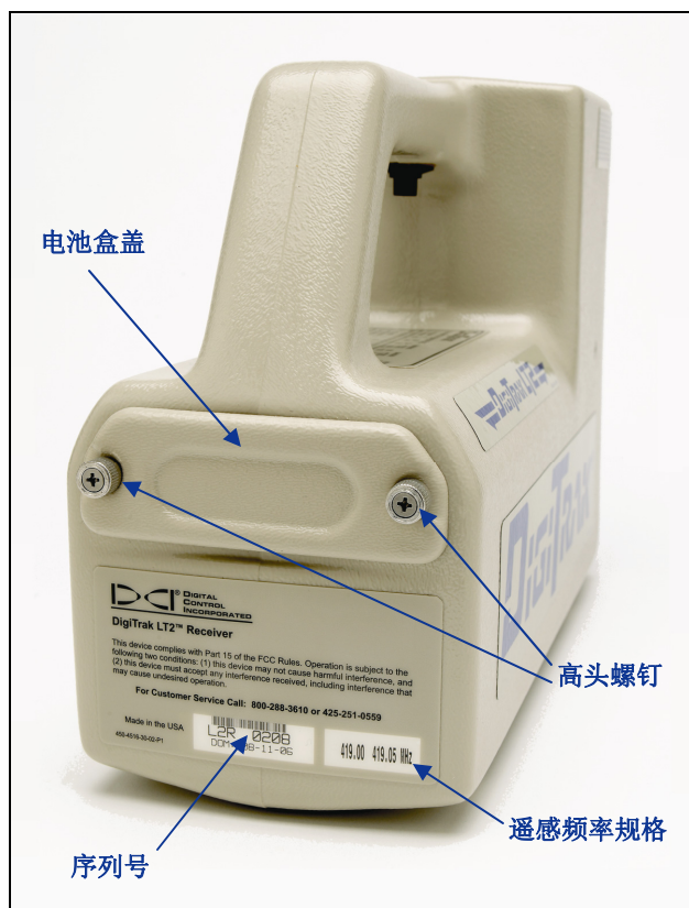
接收器背面显示出序列号码和遥感频率规格
