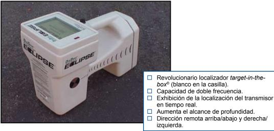
El iGPS® (inGround Positioning System [Sistema de Posicionamiento Subterráneo]) Eclipse® de DigiTrak® es un sistema revolucionario de sondeo para la industria HDD (sondeo horizontal dirigido). Es el primero de su clase en mostrar una visión global de la ubicación de la cabeza portabroca y los puntos de localización en "tiempo real".
