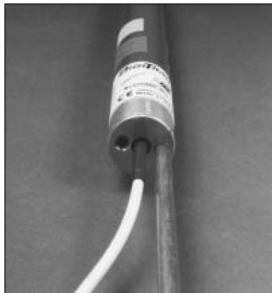
**Trasmettitore a cavo con l'estrattore/inseritore avvitato all'estremità**
