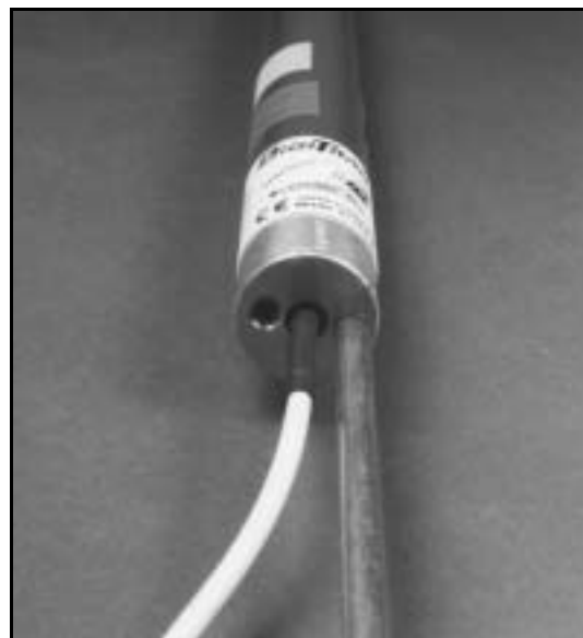
Nadajnik kablowy z narzędziem do wprowadzania i usuwania kabla wkręconym w tylną część
