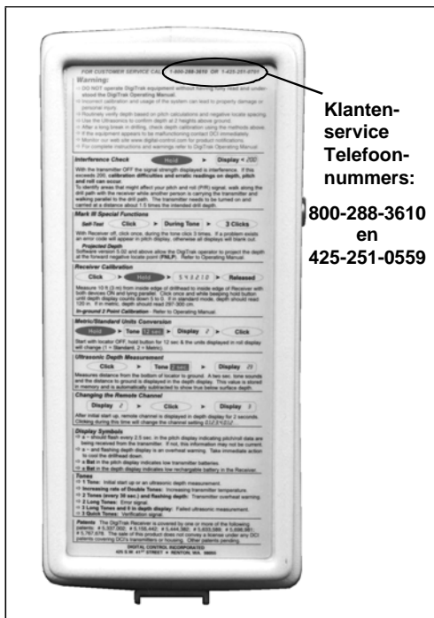
DigiTrak Ontvanger – voorpaneel met korte instructies
