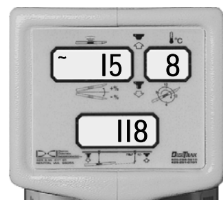
Traceerfunctie met de verticale hoek, horizontale hoek, diepte/afstand, en bijwerksymbool
