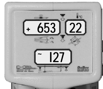
Plaatsbepalingsfunctie met de signaalsterkte, temperatuur van de zender en de verwachte diepte
