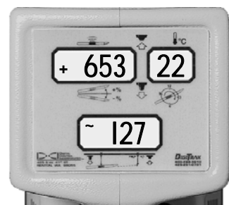
Mode de repérage montrant l'intensité du signal, la température de l'émetteur et la profondeur prédite
