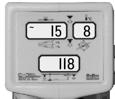
Ortungs-Modus mit Anzeige von Neigung, Drehung, Tiefe/Distanz, und Aktualisierungssymbol
