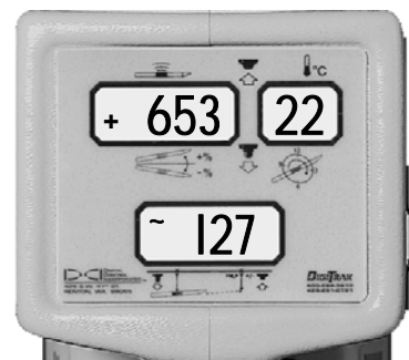
Ortungs-Modus mit Anzeige von Signalstärke, Sendertemperatur, und berechnete Tiefe
