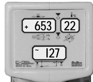
**Modo localización mostrando la intensidad de señal, la temperatura del transmisor y la profundidad prevista**
