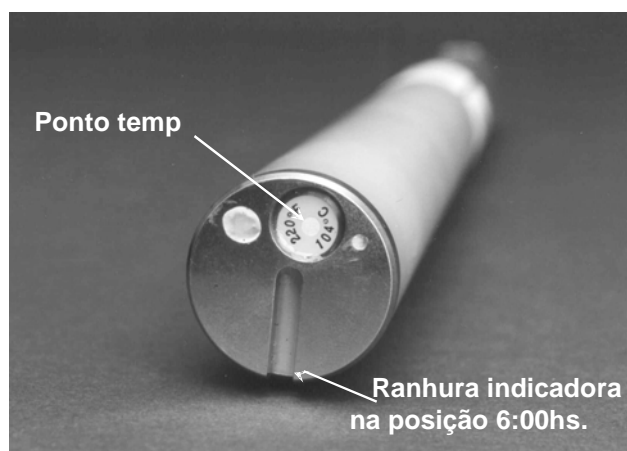
Frente da tampa posterior do transmissor mostrando o ponto temp e a ranhura indicadora
