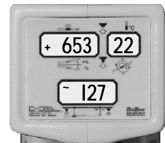
Modo “localização”- Potência de sinal, temperatura do transmissor, e profun- didade prognosticada
