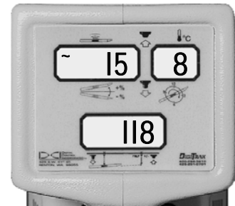
Modo “rastreamento”- Inclinação, rotação, prof./distância, e símbolo de atualização
