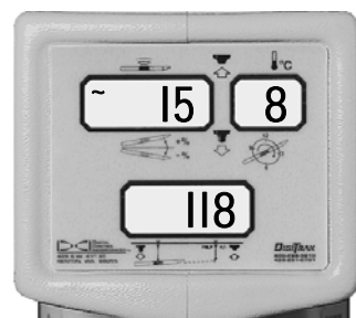
Sporingsfunktion viser hældning, rulning, dybde/afstand og opdateringssymbol
