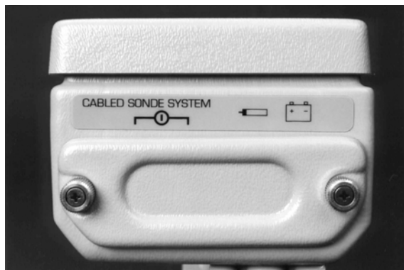
Nalepka informacyjna oznaczająca, że zdalny wyświetlacz może współpracować z nadajnikiem kablowym
