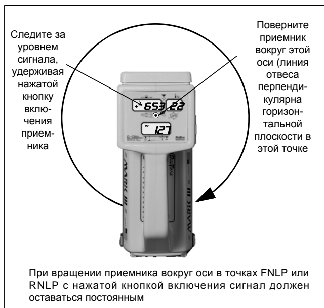
Способ проверки положения излучателя
