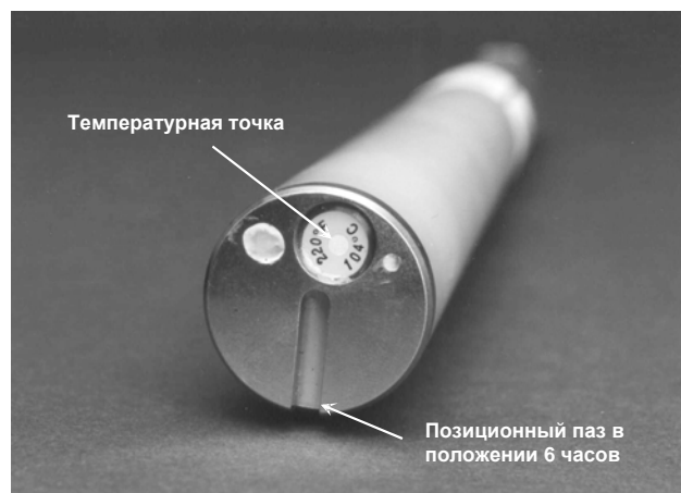
Передний колпачок излучателя, на котором видны температурная точка и позиционный паз
