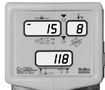
Режим слежения с отображением углов продольного и поперечного наклона, глубины/расстояния и символа обновления данных
