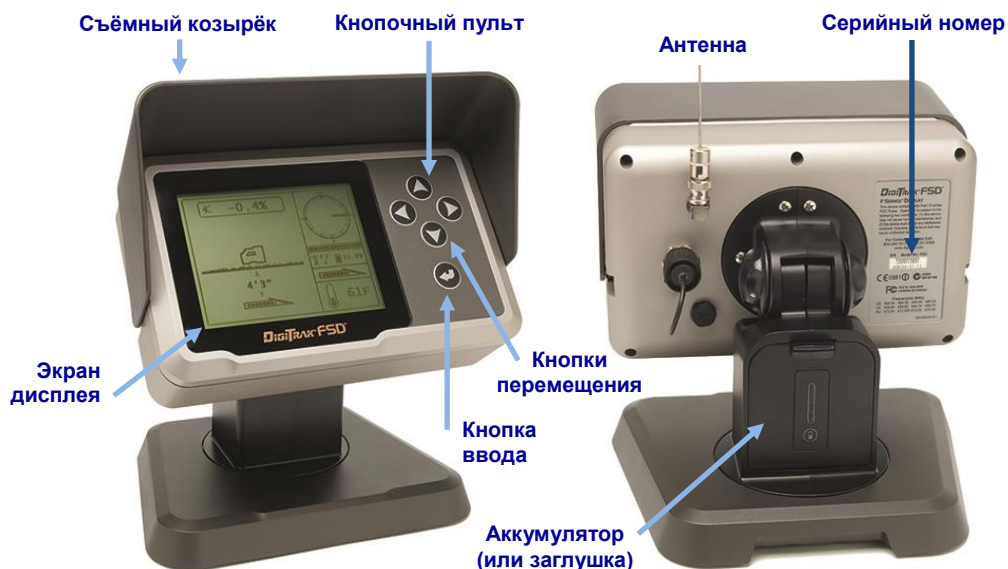
Вид дисплея DigiTrak F Series (FSD) спереди и сзади
