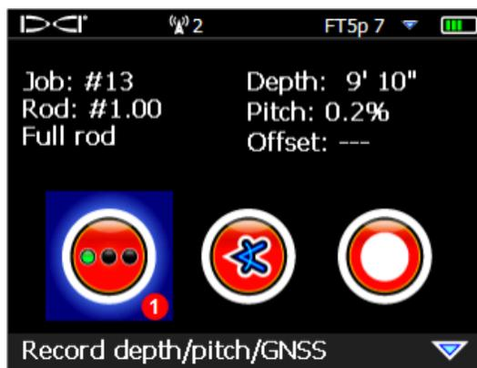
1. Кнопка записи глубины/продольного угла наклона с указателем наилучшего уровня сигнала ГНСС
