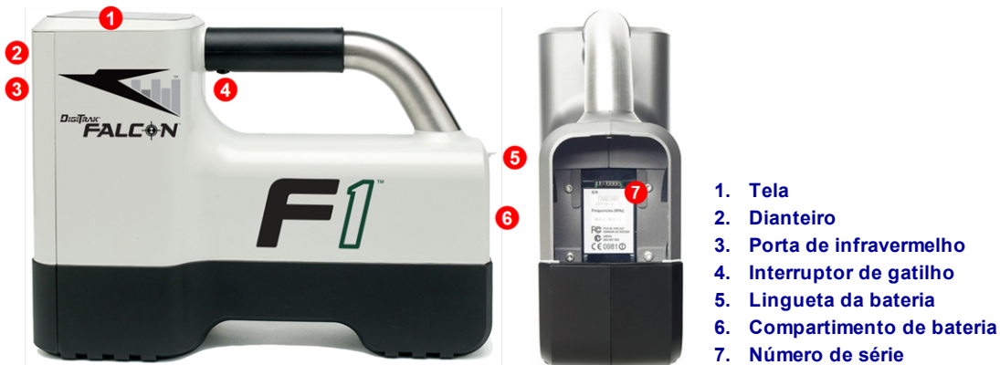
Localizador Falcon F1 - Vistas lateral e traseira
