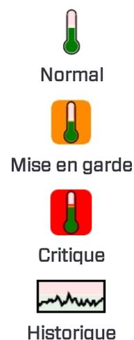
Le graphe Historique des températures, au-dessous de la température, contient les températures relevées au cours des 4 dernières minutes. Cet historique permet de déterminer si la température a tendance à augmenter ou à baisser.
