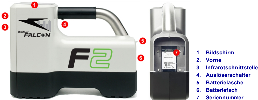
Falcon F2-Ortungsgerät – Ansicht von der Seite und von hinten
