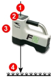
Függőleges egyenes a helymeghatározási pontok megjelöléséhez
