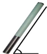
Segure o transmissor na mesma posição de horas no relógio ( $\pm 2$  horas no relógio) para todo este procedimento. Segure o transmissor ligado em nível ( $0 \pm 10^\circ$ ) por no mínimo 5 segundos. Incline o transmissor para cima aproximadamente  $+65^\circ$  (quase vertical) por 10 a 18 segundos, depois retorne-o para o nível por 10 a 18 segundos. Quando o transmissor muda as faixas, os dados desaparecem do localizador.
